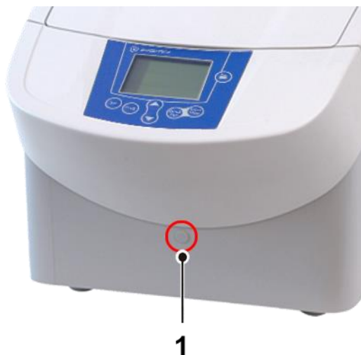
Abb. 9: Position der Öffnung für die Notentriegelung
